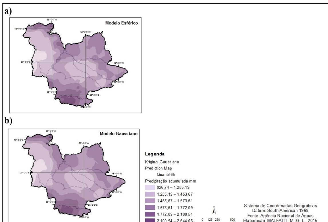
**Figura A.5: Interpolação de dados pelo método da Krigagem, para os Modelos de semivariograma a) Exponencial; b) Esférico; e c) Gaussiano, com os quantis 85 de precipitação acumulada.**
