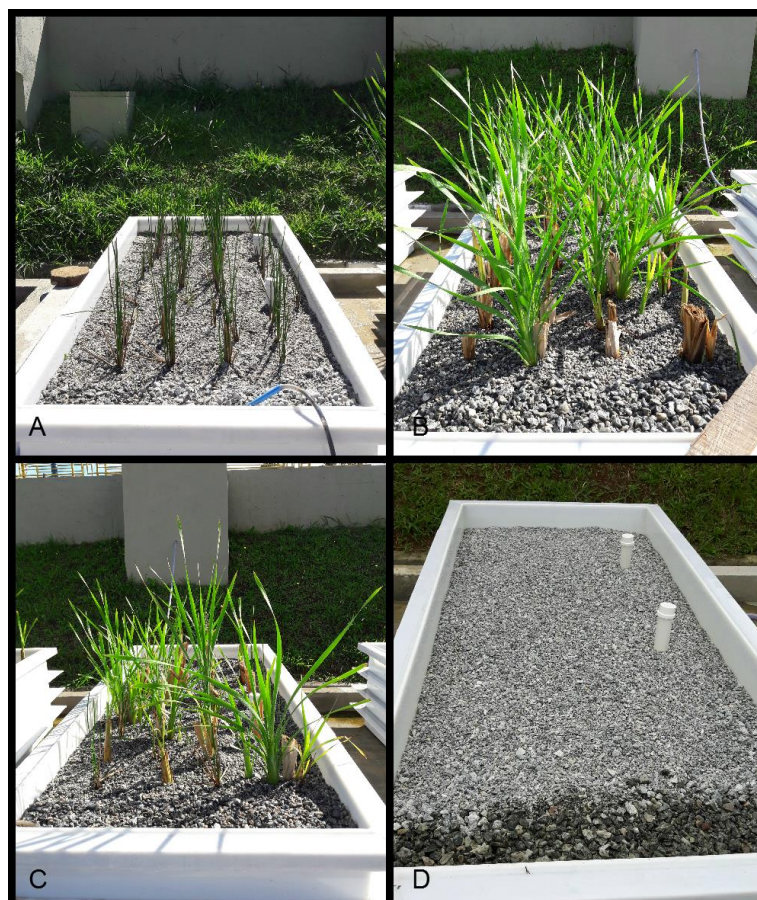
Figura 12: A) Tanque 1: tanque de PVC cultivado com Eleocharis sp. (Junco); B) Tanque 2: tanque de PVC cultivado com Typha sp. (Taboa); C) Tanque 3: tanque de PVC cultivado com Typha sp. e Eleocharis sp. ; e D) Tanque 4: tanque de PVC contendo somente brita (controle).
