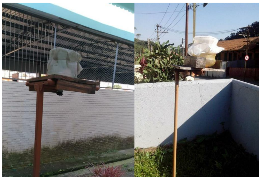
Figura 11 - Coletores manuais de deposição total nas proximidades do Polo Petroquímico de Capuava (PPC) e em Paranapiacaba.
