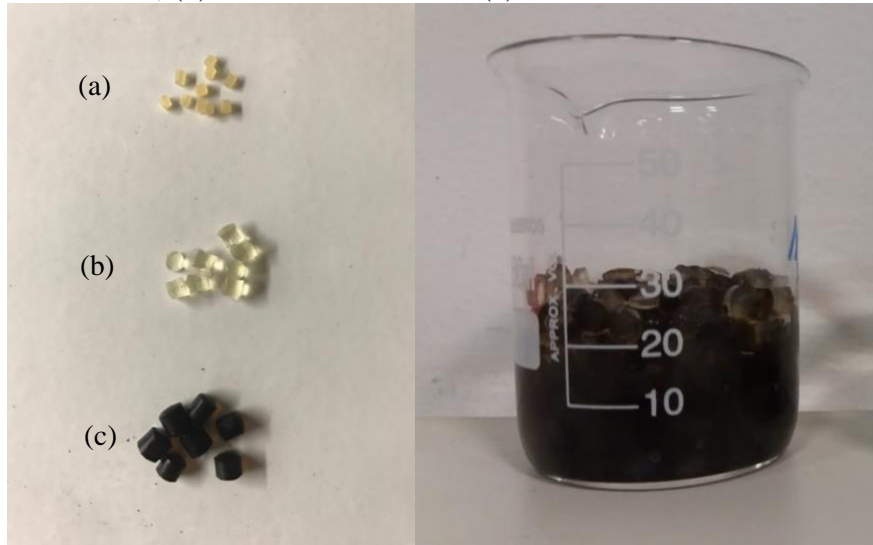
Figura 14 - Foto do material suporte poliuretano utilizado no AFMBR: (a) material desidratado; (b) material hidratado e (c) material com biofilme.
