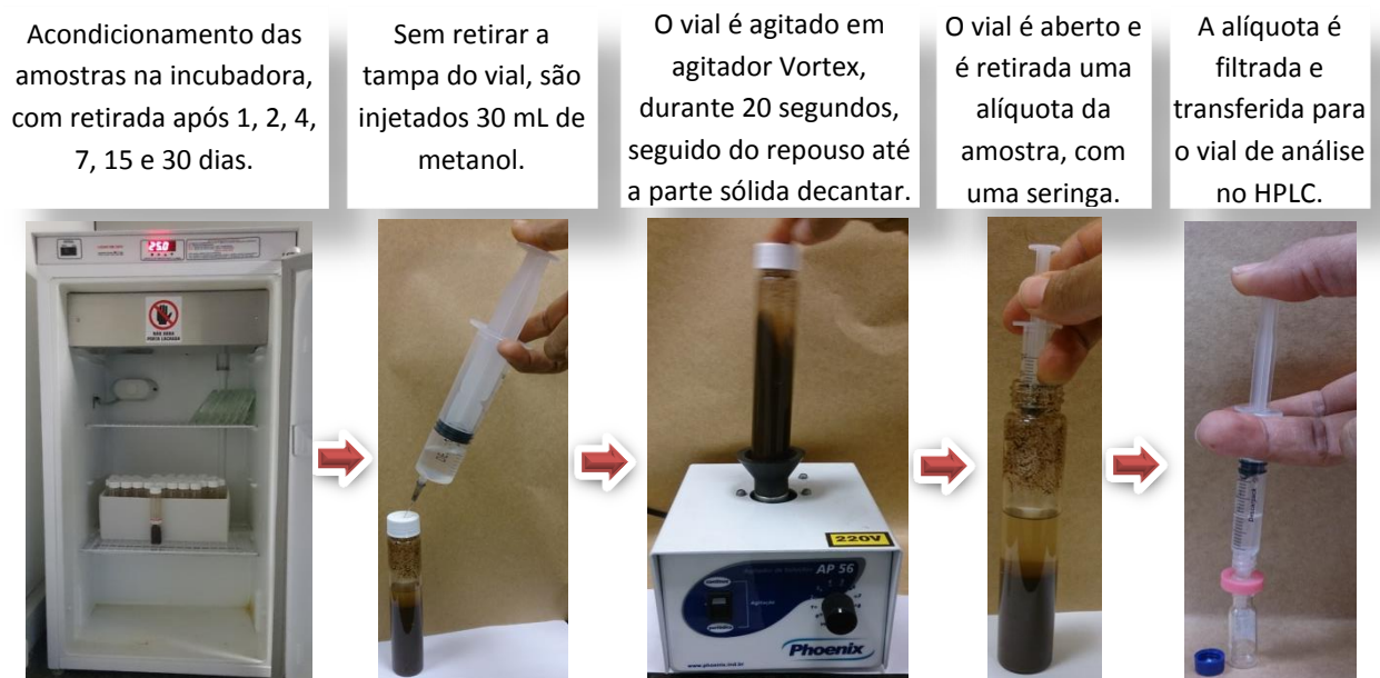
Figura 22: Esquema ilustrativo da coleta de amostras de solos normal e estéril para análise no HPLC.
