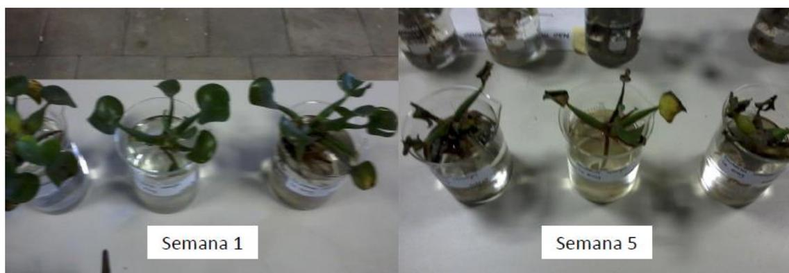
**Figura 10.** Aguapés utilizados no tratamento de água cotaminada por cobre (Cu10), durante a primeira e a quinta semana do experimento de fitorremediação.
