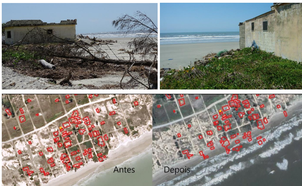
Figura 19. Casas erodidas em Ilha Comprida – SP. Os polígonos de bordas vermelha mostram a localização das edificações em 2010.
