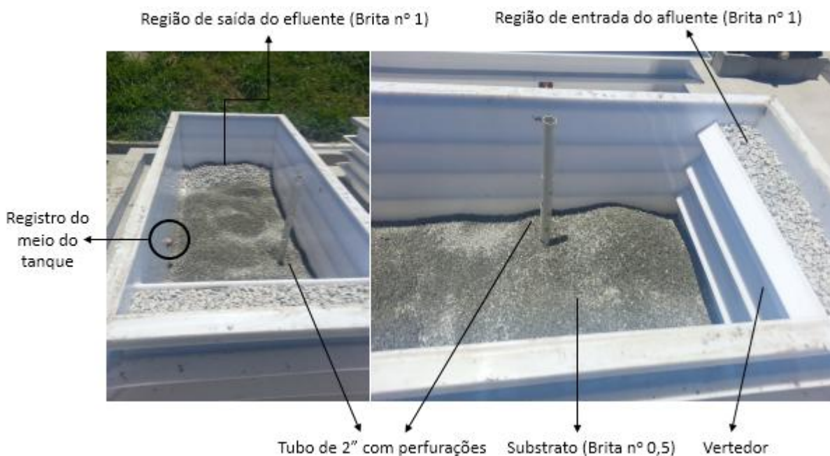
Figura 17: Fotografias da montagem do experimento (26/01/2016) com as indicações da região de entrada, saída, registro do meio do tanque e tubos para inserção da sonda.
