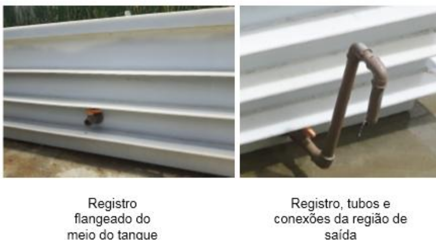
Figura 18: Fotografias da montagem do experimento (26/01/2016) com os detalhes do registro do meio do tanque, registro, tubos e conexões da saída.
