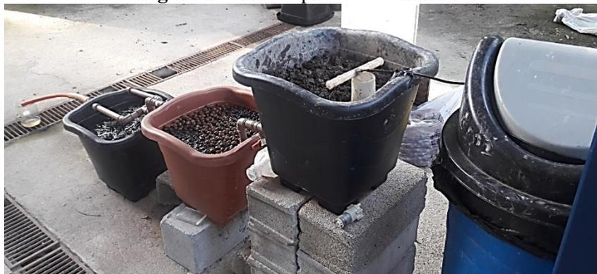
Tanto o esgoto como o efluente final (saída do R3) produzido pelo processo, foram caracterizados duas vezes por semana através da determinação das variáveis Demanda Química de Oxigênio (DQO); série nitrogenada; fósforo total e ortofosfato solúvel; alcalinidade; pH; sólidos em suspensão totais, fixos e voláteis (SST, SSF, SSV). As metodologias analíticas utilizadas seguiram à 21ª edição do *Standard Methods for Examination of Water and Wastewater*, da APHA / AWWA / WEF (2005).
